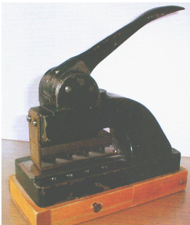
Fig. 16f: Eksempel på en matrice med 4 nålesæt samlet. Perfinbilledtype: Fig. 5e: Diagonal stilling 2
